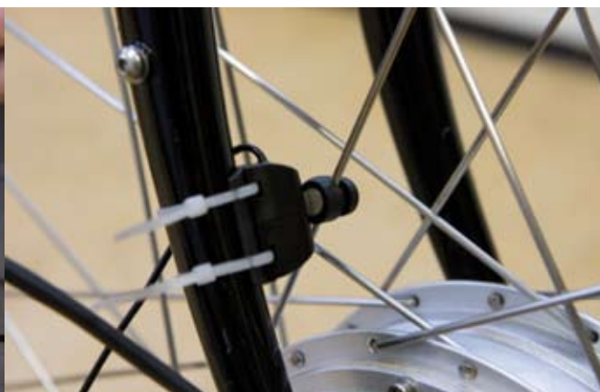
De snelheidssensor is op het voorwiel geplaatst
