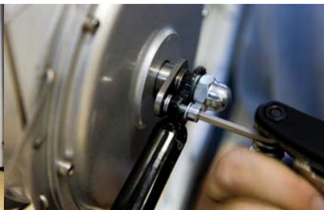
De as van de motor monteren aan de voorvork
