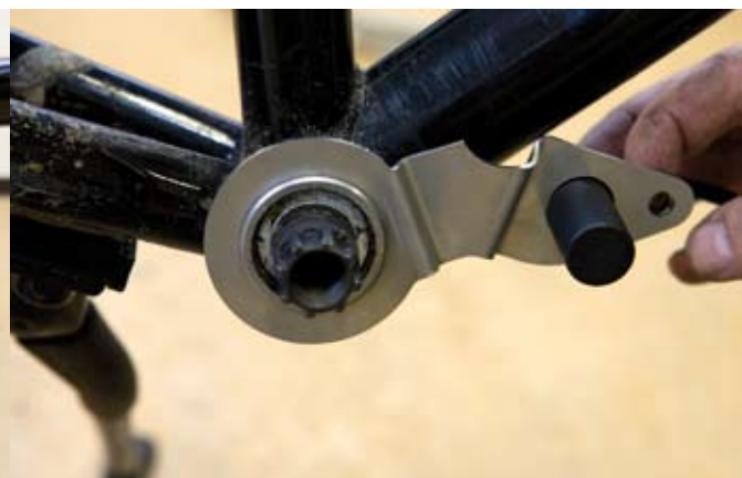
Trapas en crankstel zijn gedemonteerd om de trapsensor te plaatsen
