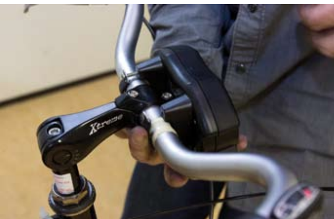
Het display op het stuur schroeven
